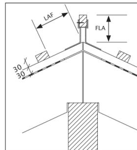
LAF = Lattenabstand zum Firstschnittpunkt (in mm)
