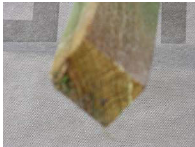
Рис.11. Поперечное сечение рейки обрешетки
