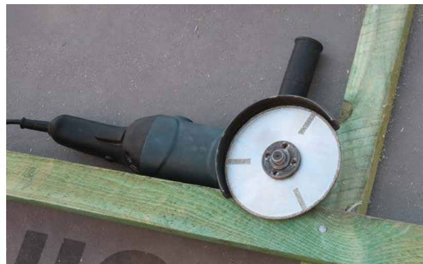
Рис.28. Инструмент для подрезания листов металлочерепицы
