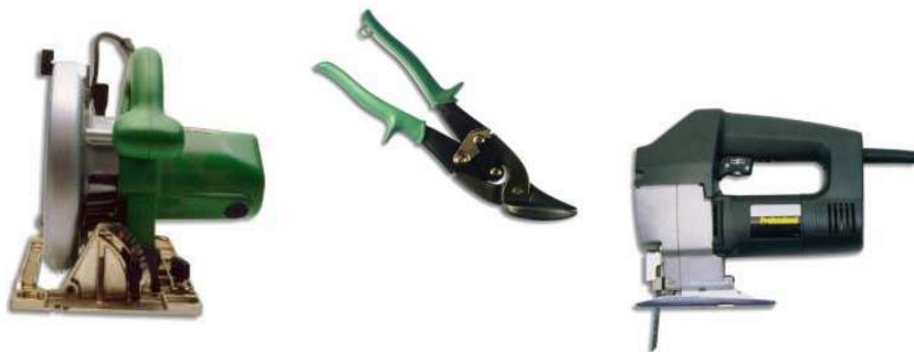
Рис.8. Инструмент для подрезки листов металлочерепицы
