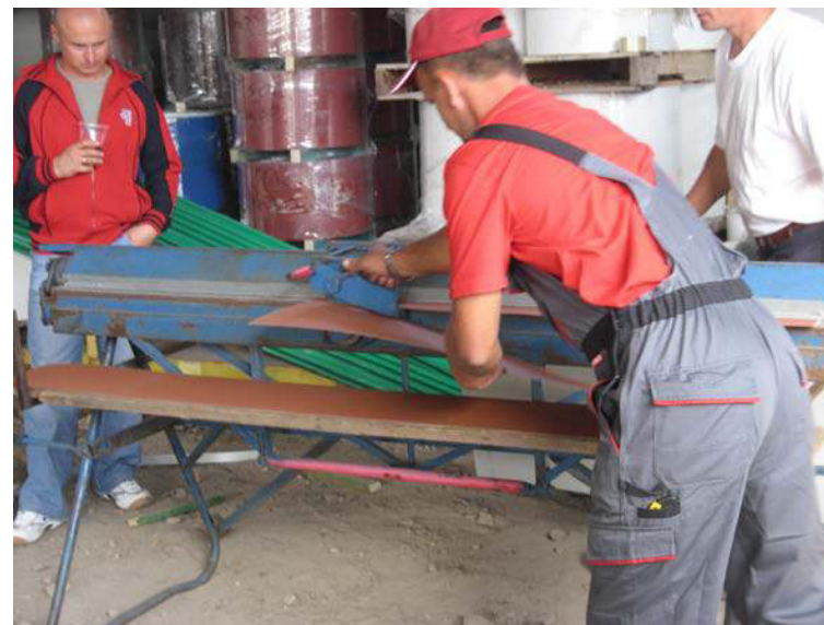
Рис.18. Разрезка плоского листа на штрипсы
