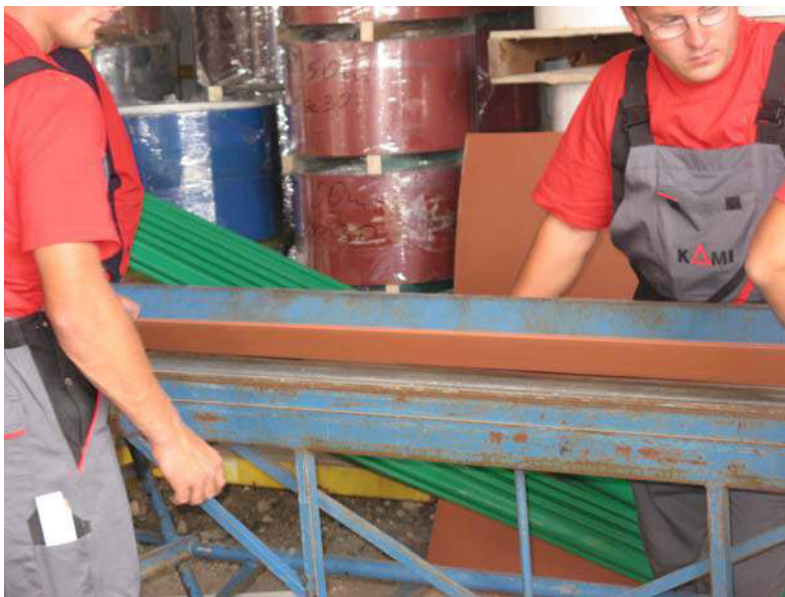
Рис.19. Изготовление планки на ручном гибочном станке
