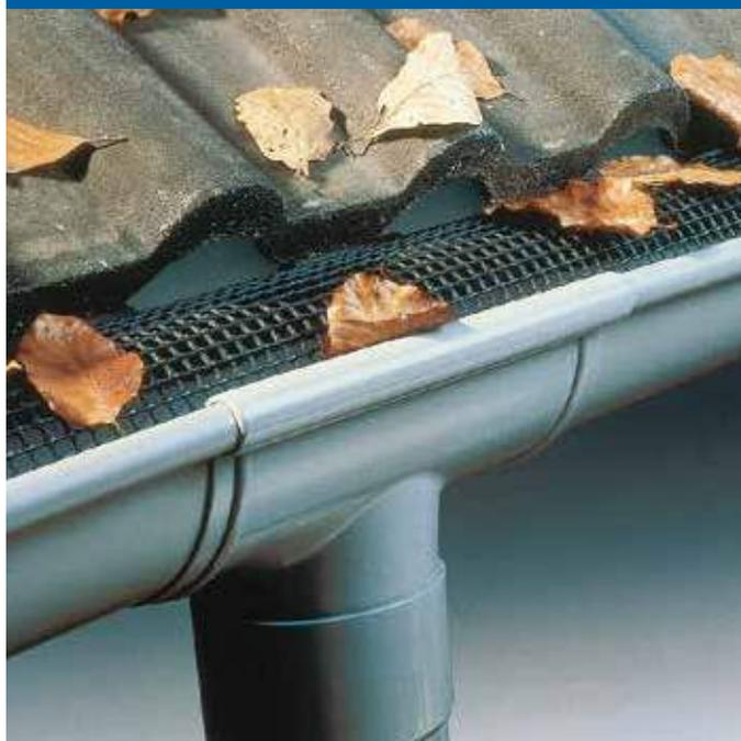
Просто положите **Marley Poly-Net Laubstop** в водосточный желоб – и у листвы не будет больше никаких шансов. Она остается лежать на круглой поверхности, высохнет и ее унесет ветер. Marley Poly-Net Laubstop из полиэтилена (ПЭ) – прочная, коррозионнотойкая, температуростойкая и на 100 % утилизуемая. Для водосточных желобов RG 150-180, RG 100-125 и прямоугольных водосточных желобов (до RG 100).
