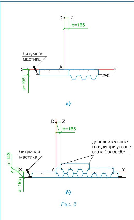
Для монтажа кровельного покрытия необходимо ровное, сухое и чистое основание, которое может быть выполнено из ОСП (ориентированно-стружечной плиты), фанеры повышенной влагостойкости, шпунтованной, обрезной доски, железобетонных плит и т.д. Стыки элементов основания следует располагать вразбежку с зазором 3–4 мм, при этом перепады по высоте не должны превышать 2 мм.
