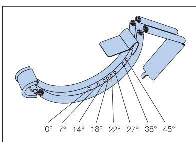
Кронштейн SSK может настраиваться на разные уклоны кровли.
