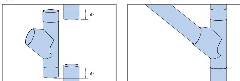
Присоедините трубу отвода. Она может быть установлена под углом 50 – 80°
