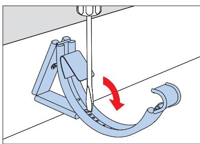
Используйте отвертку для загиба язычка вперед для низкого уклона и назад для угла  $\alpha \geq 22^\circ$ .
