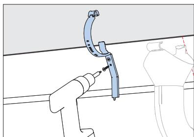
Закрепите «нижний кронштейн» на 300 мм слева от разметки трубы.
