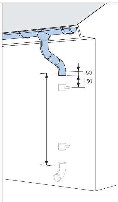
Измерьте длину водосточной трубы. Разметьте держатели труб SSVH.
