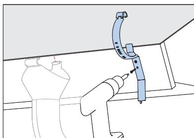
Закрепите кронштейн справа от разметки трубы выше на 2,5 мм чем нижний кронштейн.
