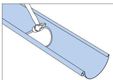
Для того, чтобы сделать равномерный выход для воды на кромках используйте молоток.
