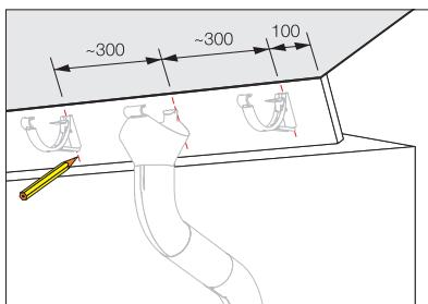
Разметьте кронштейны SSK по обе стороны от водосточной трубы.
