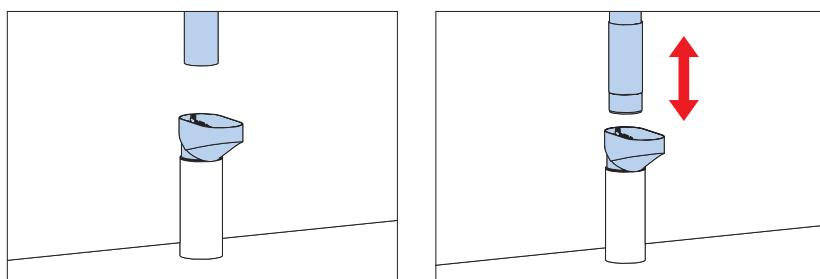
Установите сливной трап в дренажную грунтовую трубу.
