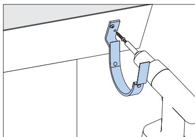
Используйте крюк K11 для уклона кровли 27°
