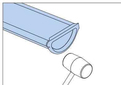
Торцевая заглушка RGT самоуплотняющаяся. Используйте резиновый молоток для того, чтобы зафиксировать ее на желобе.
