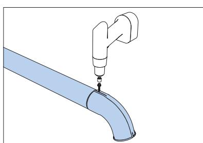
Установите башмак трубы UTK. Используйте винты – саморезы на задней стороне.
