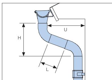
Проверьте измерения для того, чтобы определить длину промежуточной трубы MST. Используйте таблицу, показанную сбоку.
