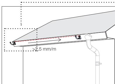
Закрепите «верхний кронштейн» на противоположном конце основания кровли. Уклон к трубе должен быть 2,5 мм/м.
