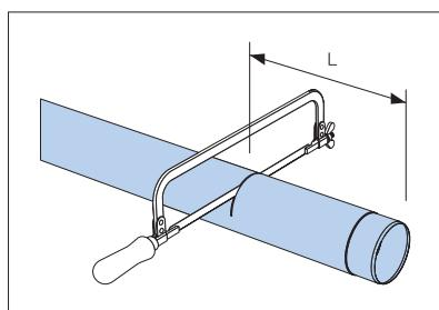
Используйте ножовку для того, чтобы отрезать промежуточную трубу MST. Удалите острые металлические заусенцы ножом.
